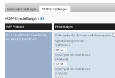
Ohne aktive Vorgabe durch das Kommunikationssystem verwendet das AGFEO Dashboard für die SIP SoftPhone Funktion die Portrange 1024 bis 65535 mit einer dynamischen Portbelegung (*Default-Einstellung!*).
